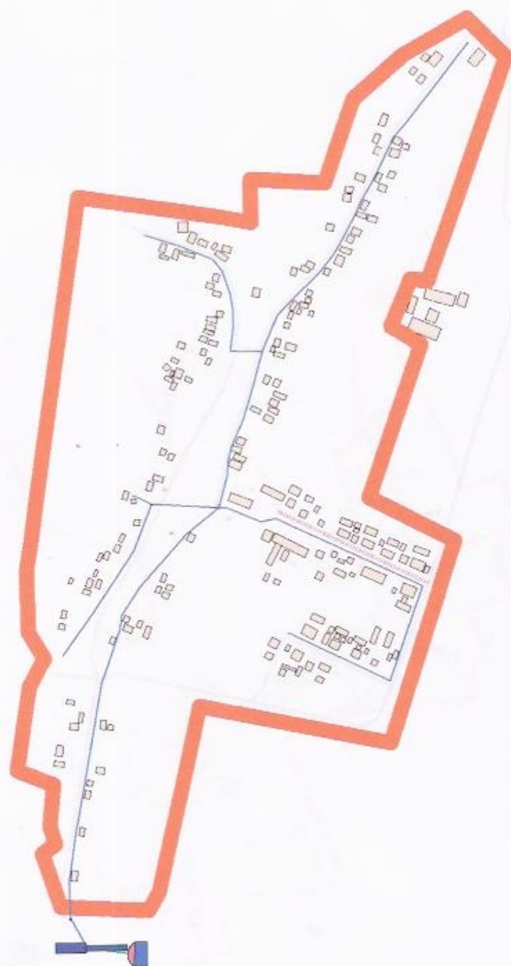
Рис.17 Водоснабжение Горцевского сельского поселения. Ильдобо
